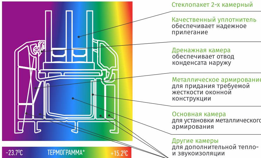
\* Расчеты производились в программном комплексе Window 6.3: -260С на улице., +210С в помещении. Двухкамерный стекло-пакет с энергосберегающим покрытием, толщина 40 мм.
